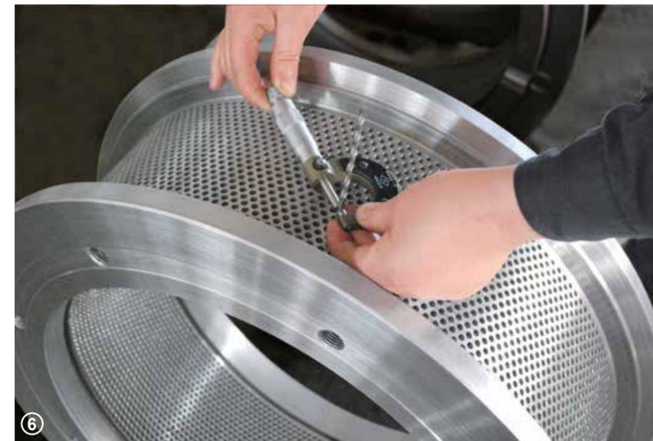
A matriz é fabricada por 29 procedimentos de processamento, dos quais os furos são formados por uma única perfuração com pistola, garantindo uma rugosidade inferior a 1,6. Os furos cônicos dentro da matriz são feitos por meio de 4 processos de furação, garantindo a suavidade do furo cônico. Um processo especial de retificação é usado para garantir ainda mais a descarga única da matriz.
